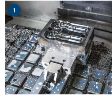
1 Schmiedewerkzeug wird gefräst
