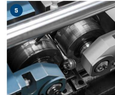
5 Das Gewinde eines Spurstangenkopfes wird geschnitten
